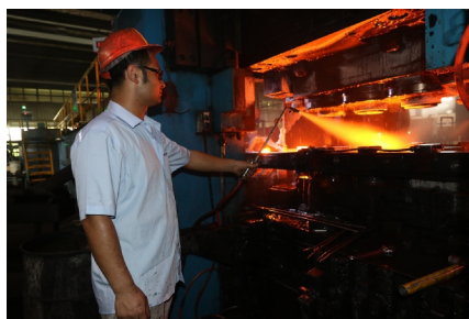
零部件事业部锻造分厂的锻打工王雅军正从炉内夹出已加热的坯料。
